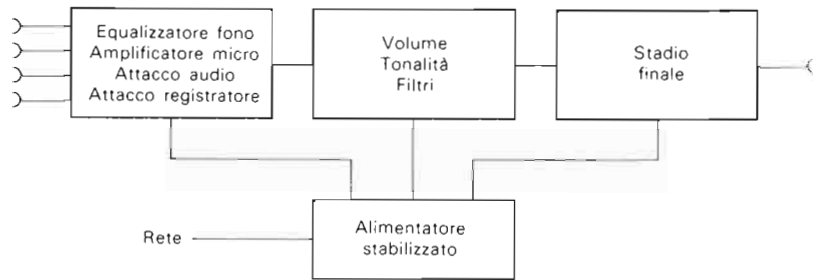
2.2 Schema a blocchi di un amplificatore HiFi
